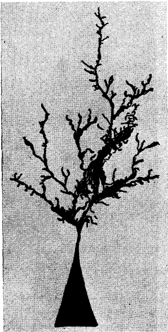
Рис. 3.15. Образование дендрита в полиэтилене.
